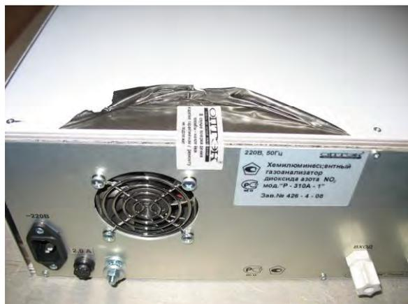
Рисунок 3 – Пломба на задней панели
