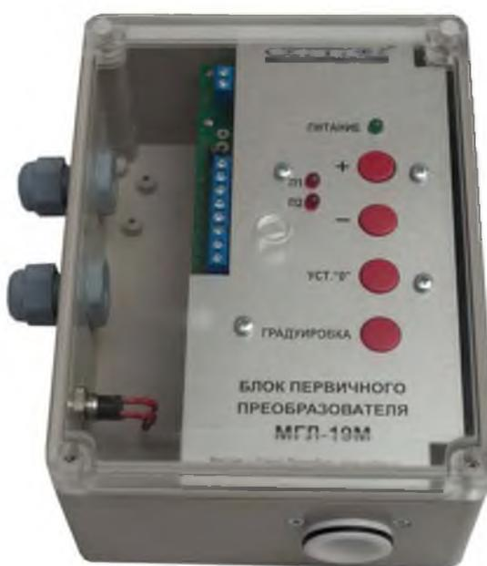
Рисунок 1 – Внешний вид моноблочного газоанализатора
